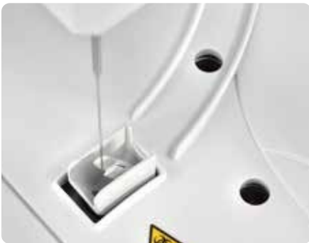
Limpieza de sonda en cascada
