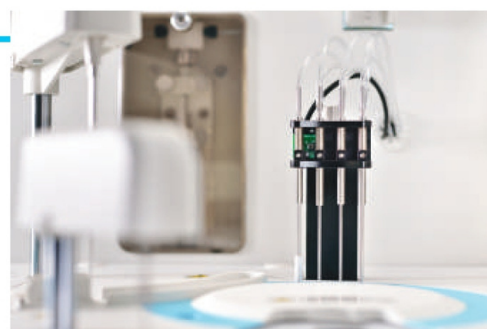
Sistema de autolavado mejorado que garantiza contaminación baja y consumo mínimo de agua.
